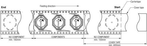
NO COMPONENT COMPONENTS NO COMPONENT min. 160mm
