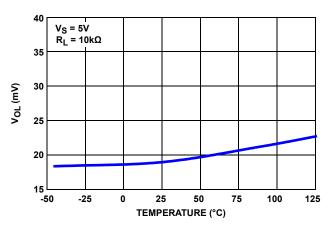
FIGURE 20.  $V_{OL}$  vs TEMPERATURE
