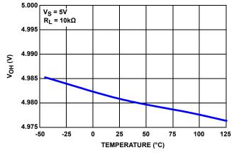
FIGURE 19. V<sub>OH</sub> vs TEMPERATURE
