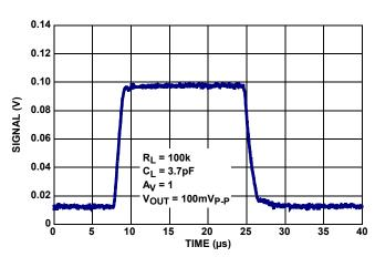
FIGURE 18. SMALL SIGNAL STEP RESPONSE (100mV)
