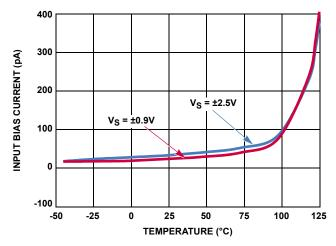
FIGURE 4. IB- vs TEMPERATURE
